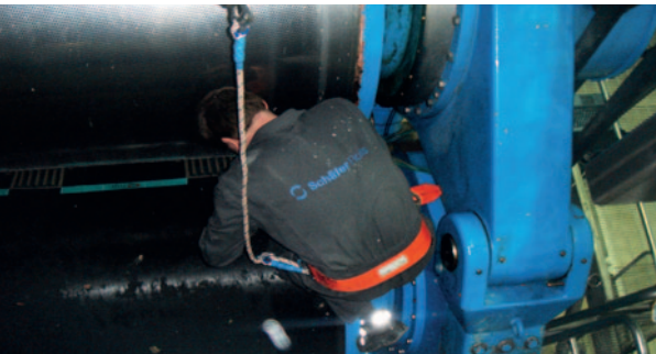
Nip-Messungen in eingebauter Walze
